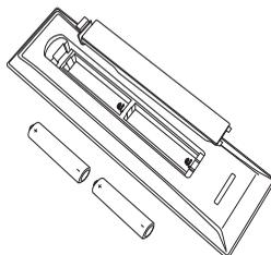
Die Rückseitenabdeckung entfernen, um das Batteriefach zu öffnen und darauf achten, dass die Batterien mit der richtigen Orientierung eingesetzt werden.
